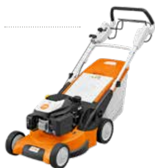
TONDEUSE TRACTÉE RM 248 T Moteur STIHL EVC 200. 139 cm 3 . 2.1 kW. Coupe 46 cm. Carter acier. Bac 55 L. Réglage hauteur de coupe centralisé (450049)
